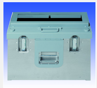
AVT-Wertkassette Transportbehälter aus Aluminium in Leichtbauweise. Außen: 370 x 498 x 390 mm (hxbxt), mit verschließbarem Deckel, mit ETS-Tragegriff, 2 Überwürfe für Plombensicherung, stapelbar.
