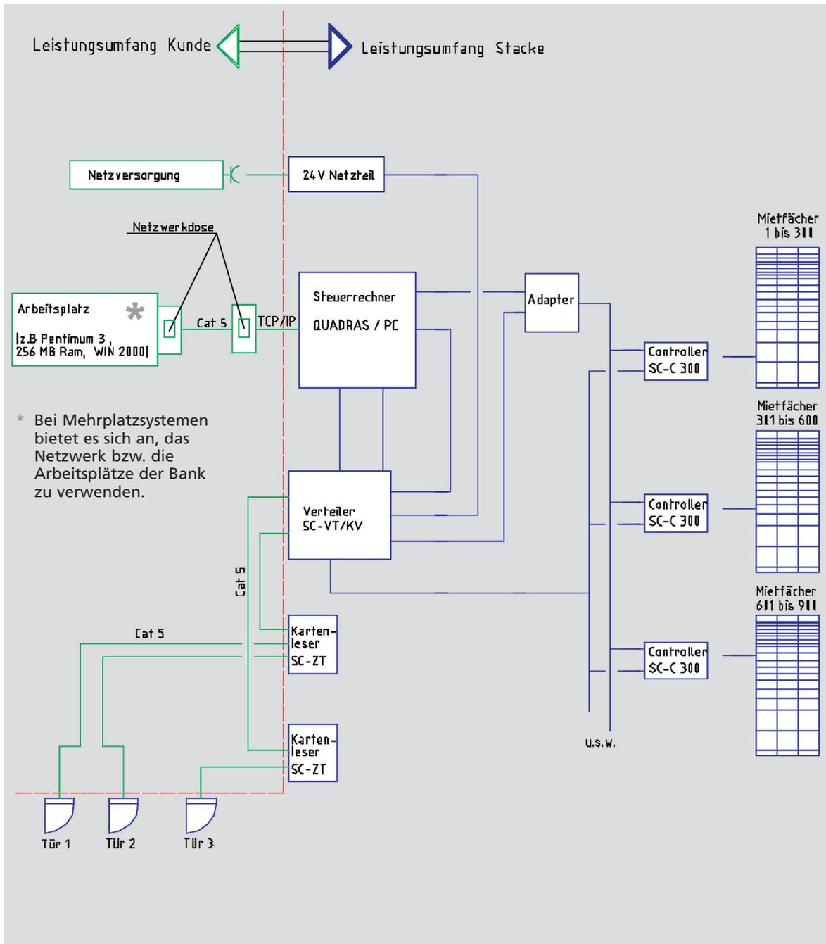
Das System und seine Komponenten in schematischer Darstellung mit der Schnittstelle „Kunde – Stacke/SAFENET“
