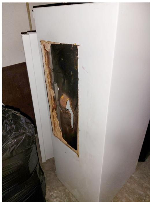
Einbruchversuch in einen ungepanzerten Sicherheitsschrank
