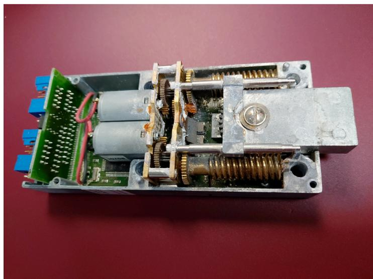
Vom Hochwasser beschädigter Motorschlossriegel der Tresortür
